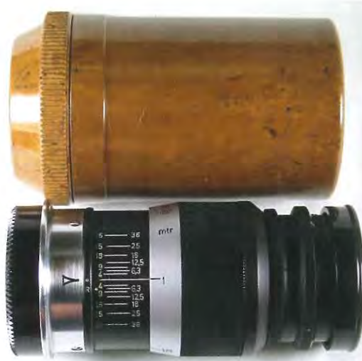
Esempio di obiettivo Elmar da 9cm nella finitura nera opaca tipica del primo periodo post-bellico: la stessa finitura è adottata per alcune partite di obiettivi Hektor da 13,5cm. Notare l'astuccio dello stesso periodo.
